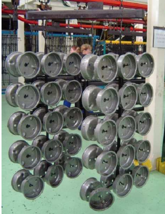
Figura 5. Imagem de várias peças dispostas em uma barra de carga. Fonte: Endosul Pinturas Automotivas Ltda
