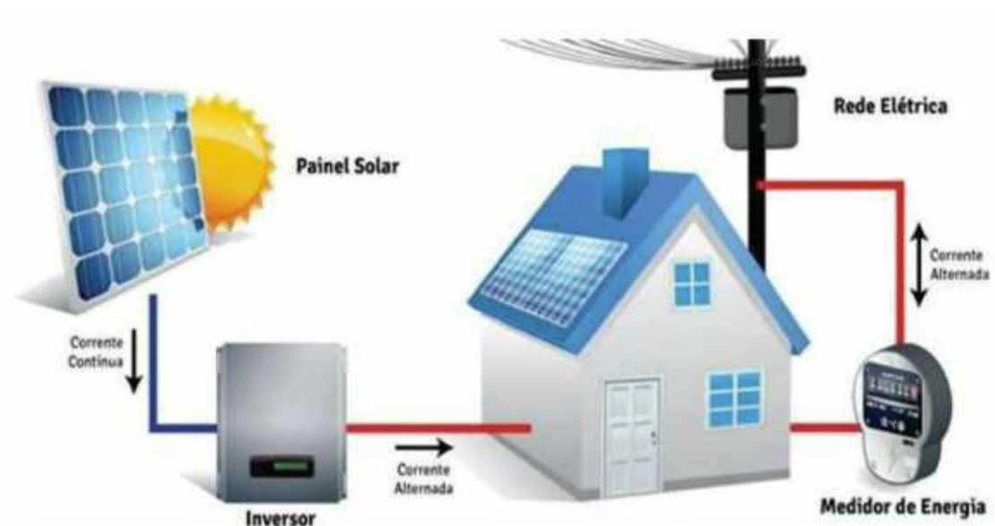
Figura 05 – Ilustração sistema fotovoltaico
