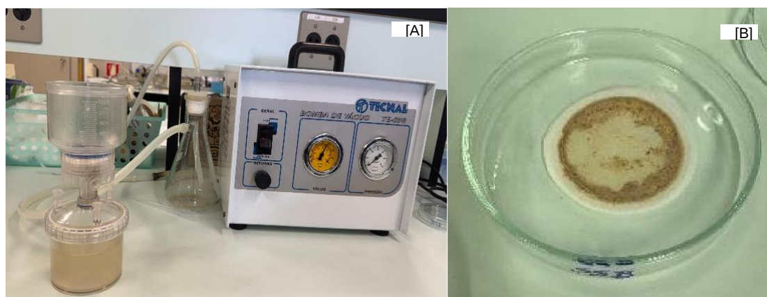
Figura 10 - Separação da biomassa do meio fermentado por filtração a vácuo [A] e papel filtro com biomassa úmida antes da secagem [B].
