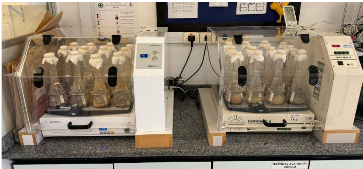
Figura 9 - Representação do cultivo de Aspergillus oryzae em frascos Erlenmeyer, conduzidos em agitadores de bancada.
