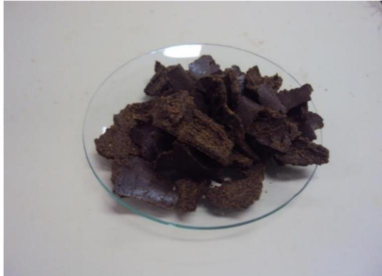
**Figura 1.** Aspecto visual do BSNF após a extração do óleo da semente do nabo forrageiro (próprio autor).
