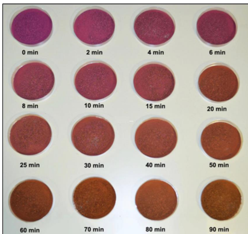
Figura 3 – Mudança na coloração observado ao longo de 90 minutos no conteúdo de sachês comerciais contendo \text{KMnO}_4 suportados em material inerte quando expostos a uma atmosfera de etileno.
