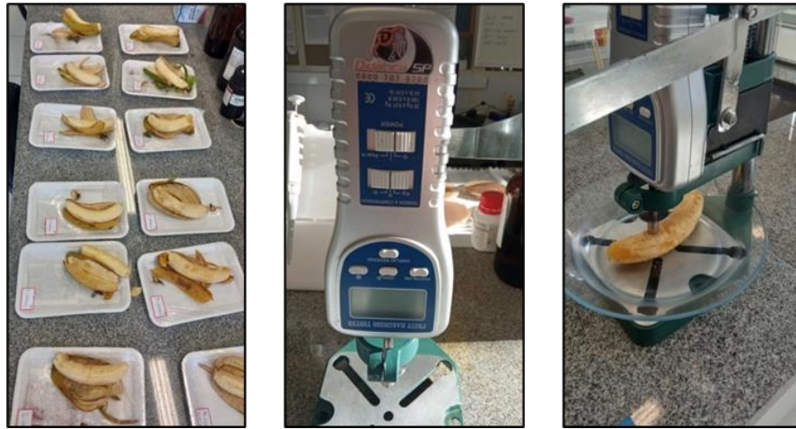
Figura 16 – Fotografias representando o ensaio de firmeza demonstrando os frutos após o 22º dia de ensaio sem as cascas (direita), o penetrômetro de bancada (centro) e o ensaio de firmeza.
