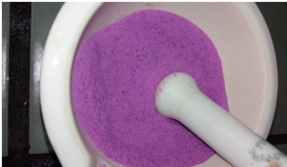
Figura 6 – Mistura obtida a partir da maceração da matriz sólida constituída de sílica e o \text{KMnO}_4 como o agente removedor do etileno
