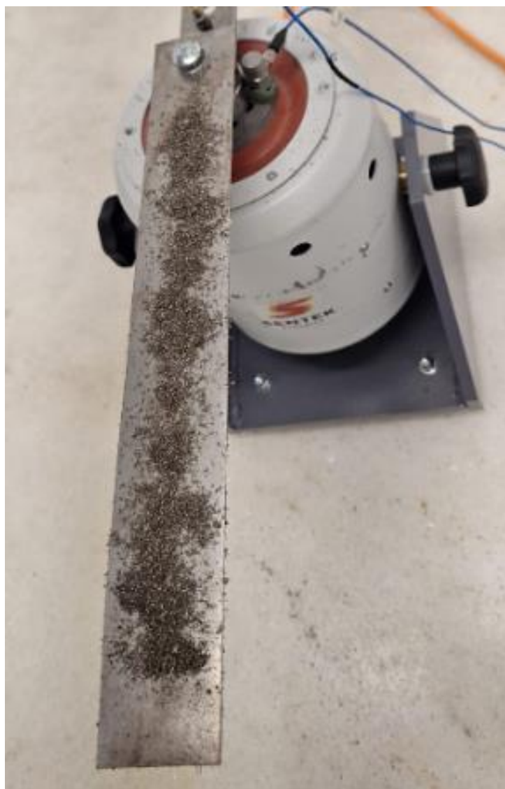
Figura 26 - Viga nº1 com limalha de ferro montada no shaker
