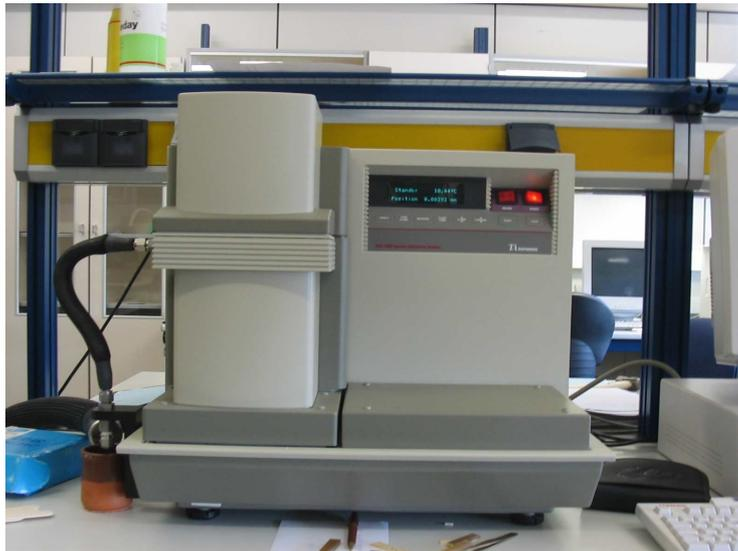
Figura 22 – Equipamento para ensaios de análise de DMA modelo 2980 da TA *Instruments*
