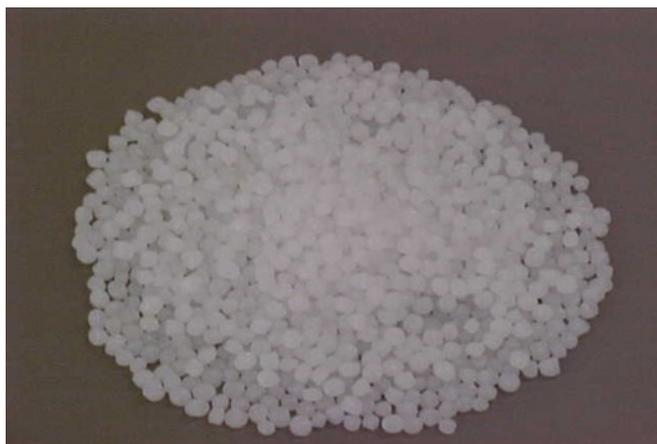
Figura 12 – Aspecto do polietileno de alta densidade (HC 7260 LS)
