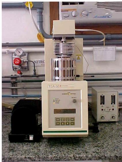
Figura 19 – Balança termoanalítica, Shimadzu, modelo TGA-50
