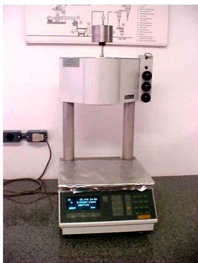
Figura 26 – Equipamento para a medição do índice de fluidez (IF)
