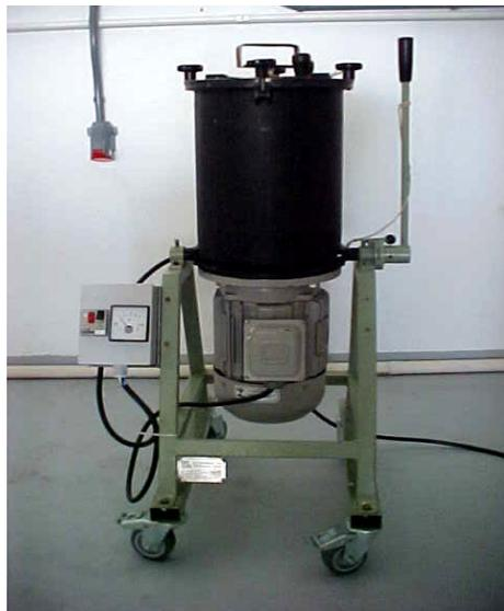
Figura 14 - Desfibrador utilizado para processar o resíduo têxtil
