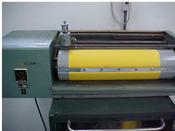
Figura 25 – Equipamento para análise de resistência à abrasão
