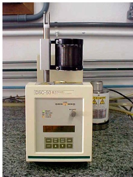
Figura 21 - Equipamento para análises de DSC, Shimadzu, modelo DSC-50
