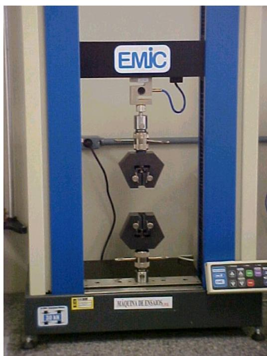
Figura 23 – Equipamento para análise de resistência à tração e à flexão
