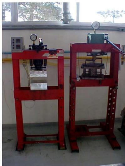
Figura 18 – Prensa com aquecimento (lado esquerdo) e prensa sem aquecimento (lado direito)
