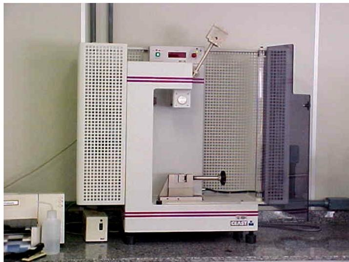
Figura 24 – Equipamento para análise de resistência ao impacto IZOD
