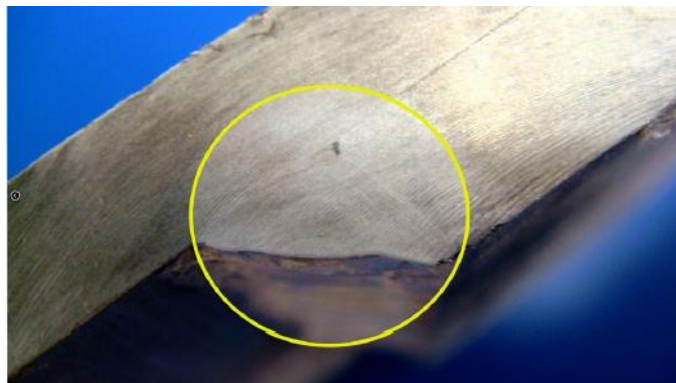
Figura 6 – Falta de fusão na solda GTAW.
