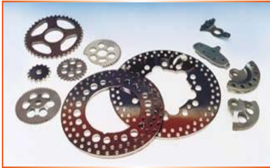
Figura 1: Exemplos de peças com requisitos de alta qualidade cortadas por cisalhamento
