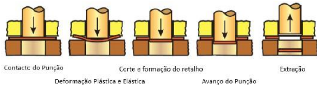
Figura 2: Etapas do corte por cisalhamento
