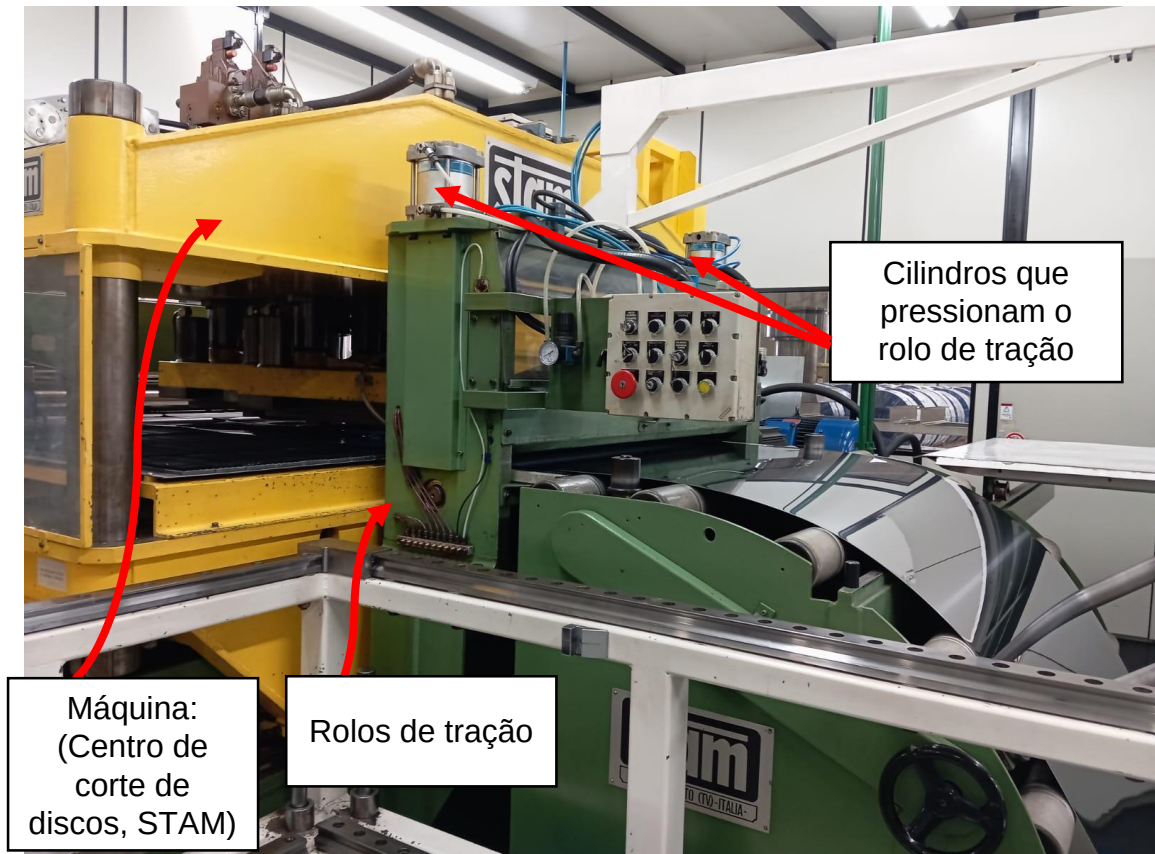
Figura 11: Representação da estação com os rolos de tração
