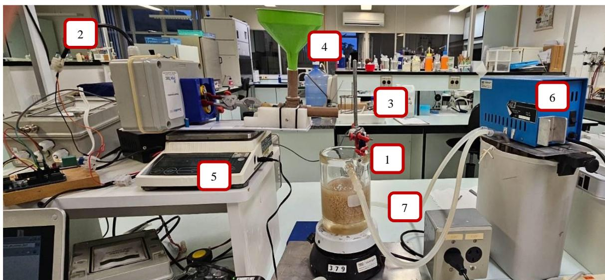
(1) reator enzimático; (2) controlador de pH; (3) sonda de pH; (4) motor de passo com  $\text{Ca}(\text{OH})_2$ ; (5) balança semi-analítica; (6) controlador de temperatura; (7) agitador magnético; (8) sistema de controle Arduino.
