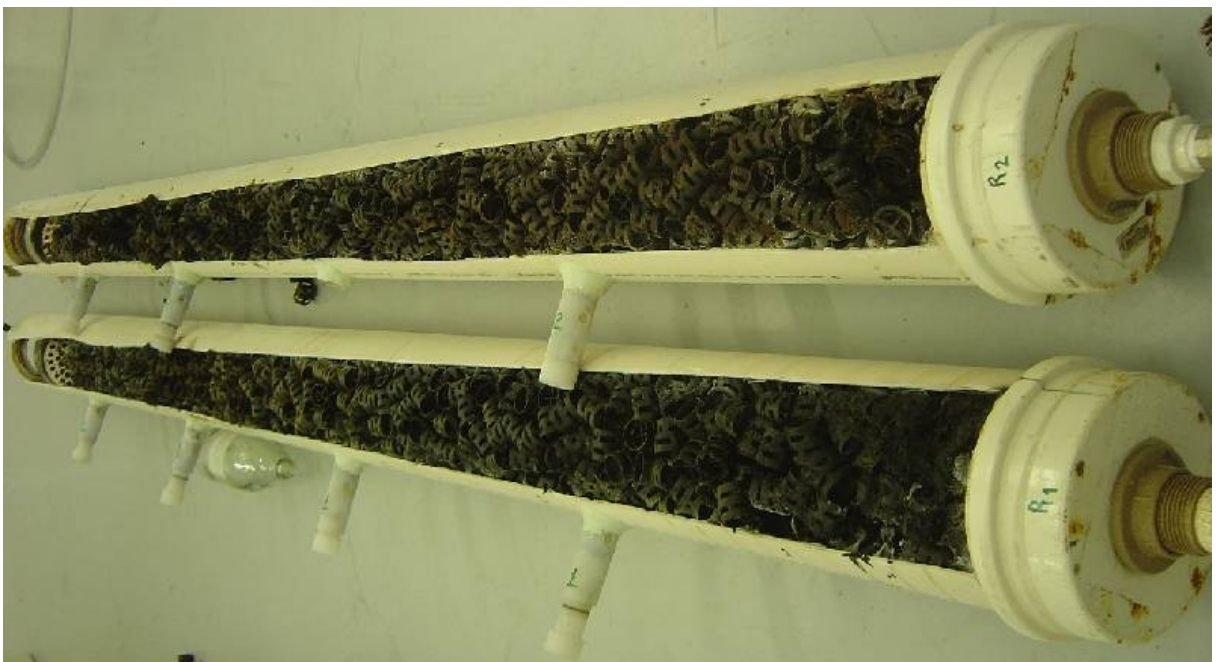
Figura 41. Vista dos reatores R_1 e R_2 cortados longitudinalmente.
