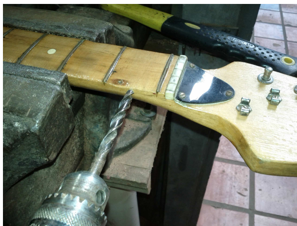
Figura 50 – Posição da furadeira no primeiro corte, com guitarra presa à morsa
