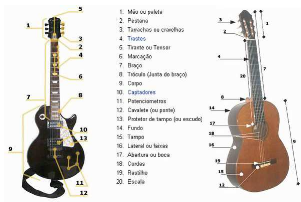
Figura 8 – Partes de uma guitarra e um violão
