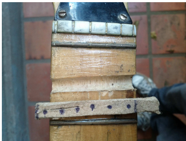
Figura 54 – Produção falha do suporte dos LEDs em compensado
