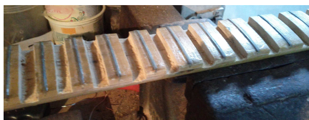
Figura 53 – Espaços abertos para os LEDs no braço da guitarra
