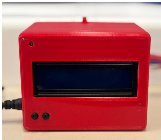
Figura 19 - Case de proteção, (visto de frente) para o dispositivo de controle
