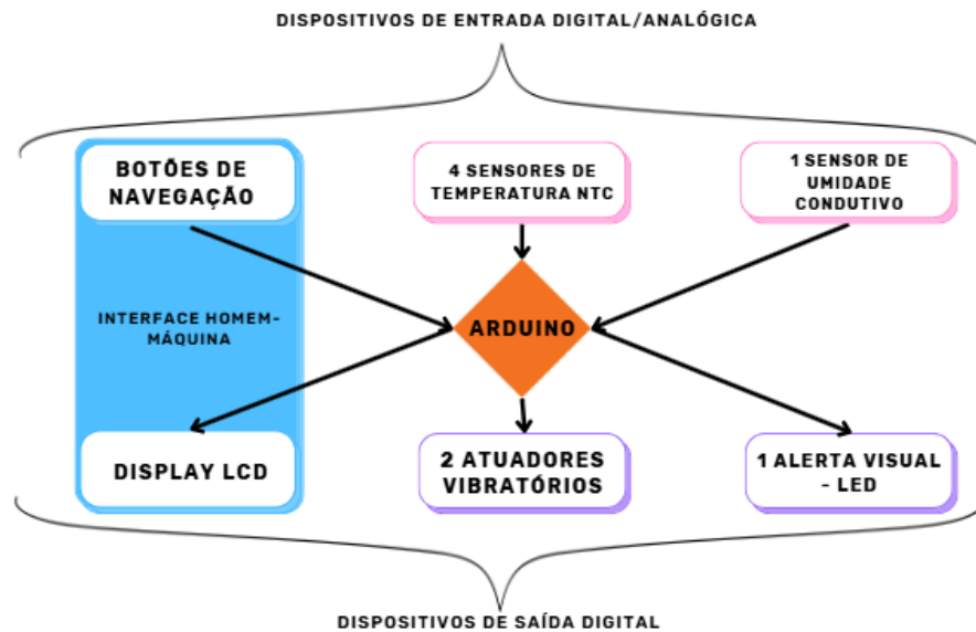
Figura 18 - Arquitetura do sistema e interação entre o Arduino UNO e os dispositivos de entrada e saída
