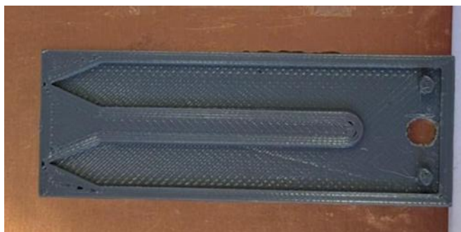
Figura 21 - Suporte do sensor de umidade
