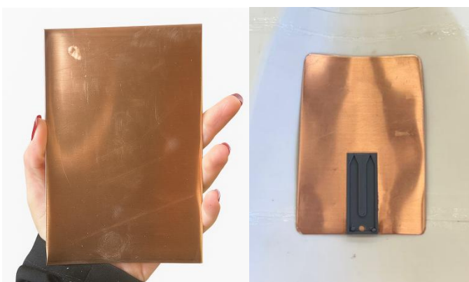
Figura 7 - Chapa de cobre antes e depois de sua conformação e arredondamento dos cantos vivos
