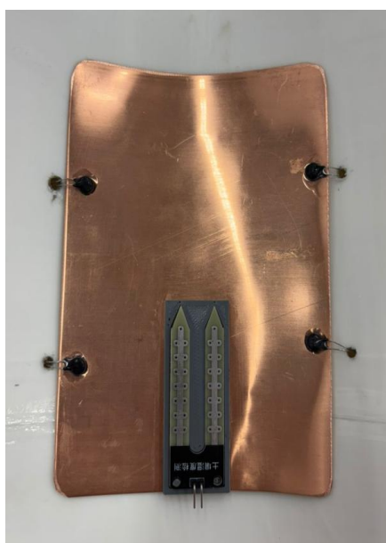
Figura 15 - Chapa metálica com sensores NTC acoplados
