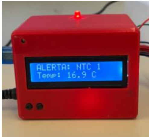
Figura 27 - Alerta de variação de temperatura, LED aceso
