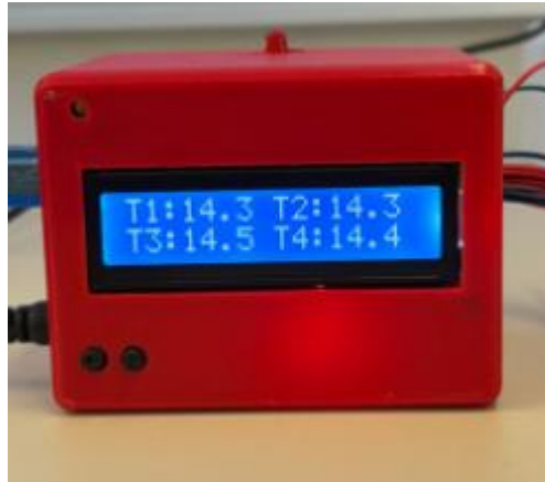
Figura 26 - Display contendo as temperaturas medidas em tempo real
