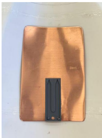
Figura 22 - Suporte de sensor de umidade posicionada na chapa de cobre
