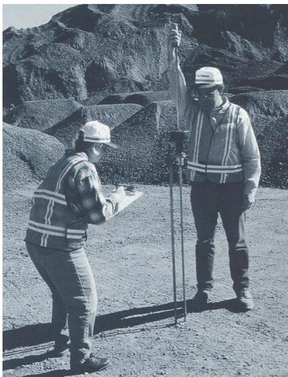
Figura 2 - Ensaio DCP, guia de uso do DCP, Mn/DOT
