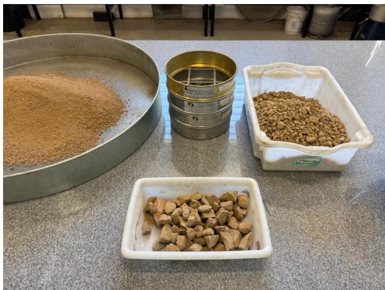
Figura 56 - Separação e substituição de material
