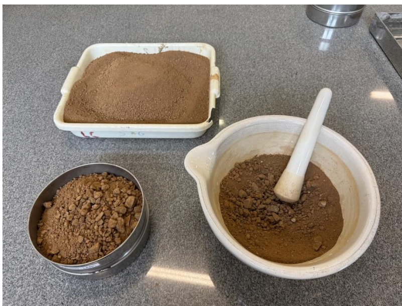
Figura 23 - Processo de destorroamento e peneiramento
