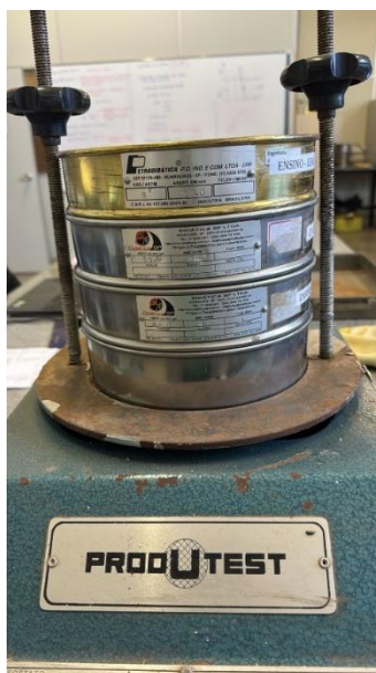
Figura 55 - Peneiramento para substituição de material
