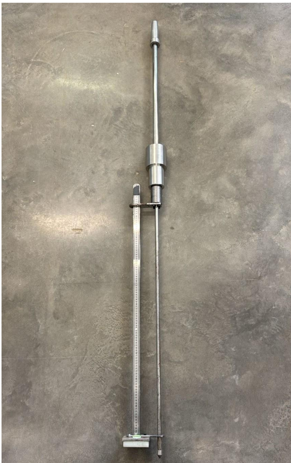
Figura 21 - Cone de Penetração Dinâmica - DCP
