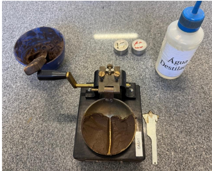
Figura 27 - Aparelho de Casagrande antes da aplicação dos golpes
