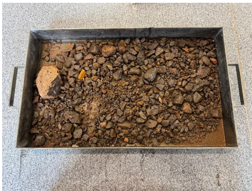
Figura 32 - Material retido na peneira de 2,0 mm
