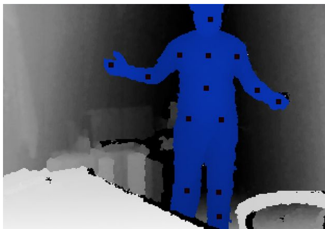
Figura 5.3: Pontos gerados através da detecção do usuário realizada pelo NiTE. Fonte: FALAHATI (2013)
