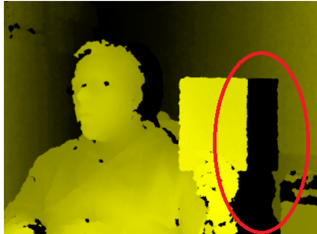
Figura 4.2: Sombra gerada pela luz infravermelha.
