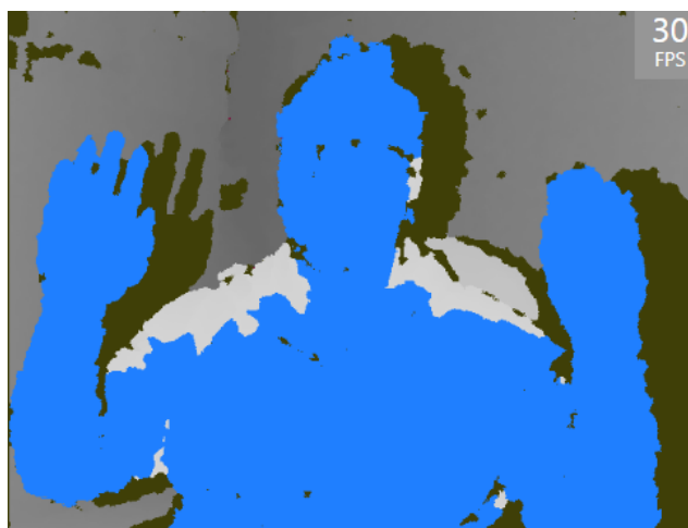
Figura 5.7: O Microsoft Kinect SDK detecta o usuário mas não consegue gerar o esqueleto à uma curta distância.
