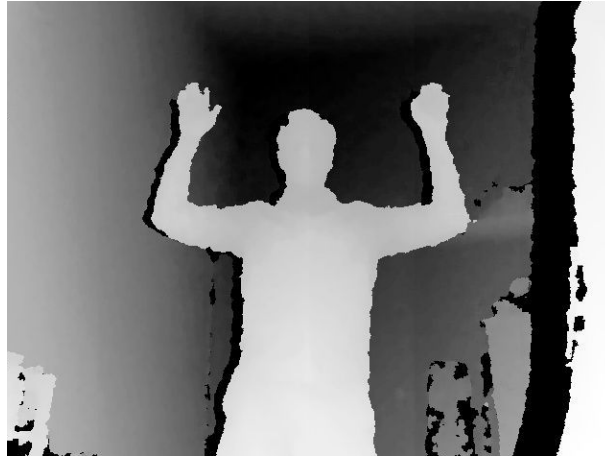
Figura 5.2: Pose “Psi” para calibragem e detecção do usuário. Fonte: BORENSTEIN (2012)
