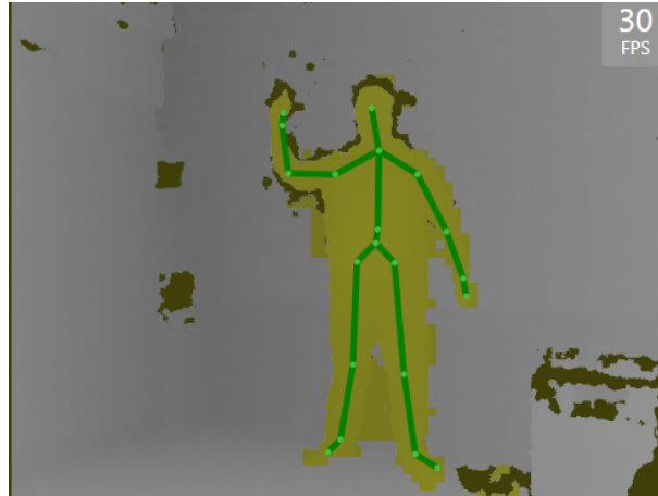
Figura 5.4: Esqueleto gerado através do Microsoft Kinect SDK no modo em pé.
