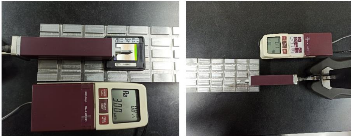
Figura 31 – Rugosímetro SJ-201 utilizado nos ensaios
