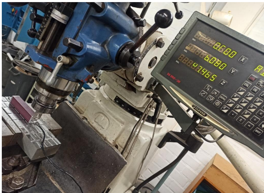
Figura 35 - Fresadora convencional utilizada para fixar o rugosímetro.
