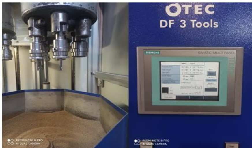
Figura 29 – Máquina de acabamento por arraste em mídia abrasiva
