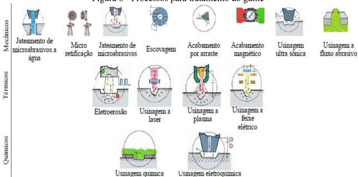
Figura 6 - Processos para tratamento do gume
