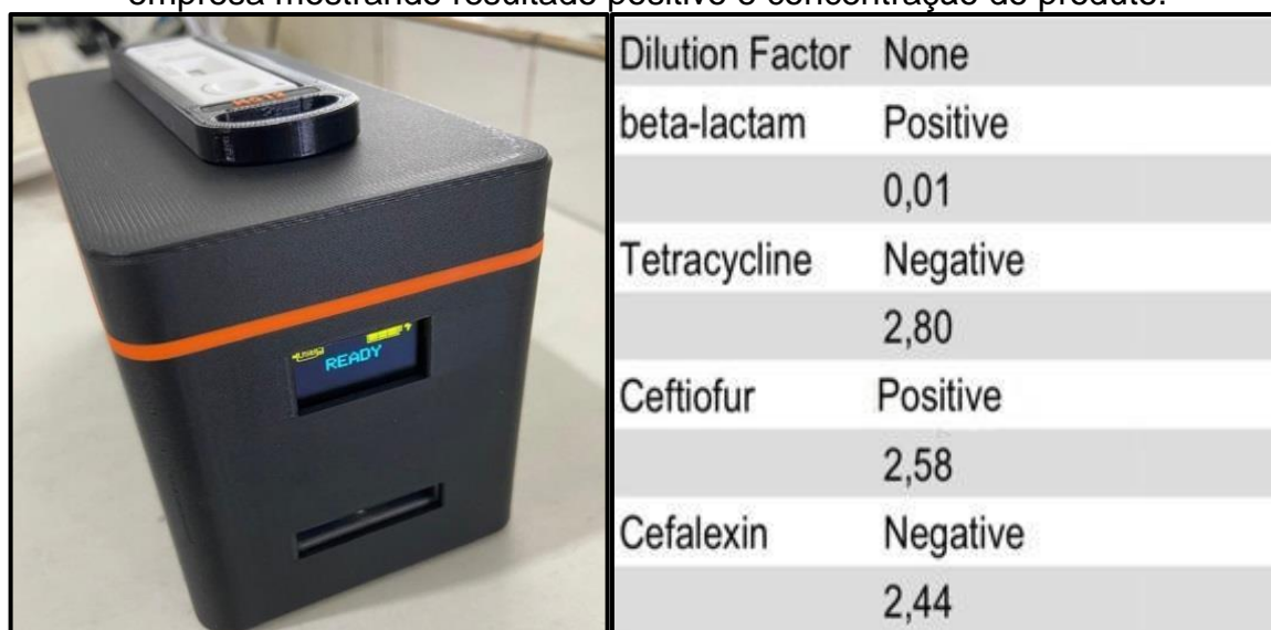
Figura 20 – Teste quantitativo complementar ao teste qualitativo utilizado na empresa mostrando resultado positivo e concentração do produto.
