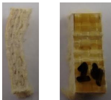
Figura 38 - Corpos de prova obtidos no ensaio ILSS
