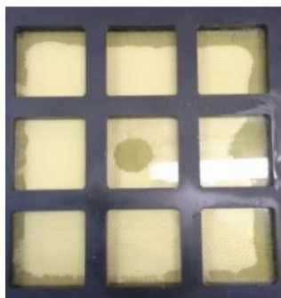
Figura 31 – Race-tracking na moldagem do compósito AD4
