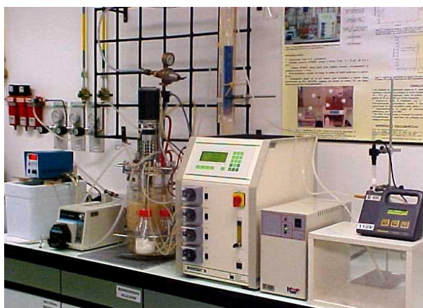
Figura 4 - Sistema de fermentação utilizado no cultivo de Bacillus thuringiensis var. israelensis em fermentador de bancada BIOSTAT B (B. BRAUN).
