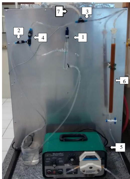
Figura 10: Sistema empregado na conversão do lactobionato de sódio em ácido lactobiônico. [1] sonda de pH; [2] válvula para a saída da amostra; [3] válvula para a entrada da amostra; [4] válvula para a circulação; [5] bomba peristáltica; [6] resina catiônica ácida; [7] entrada da amostra.
