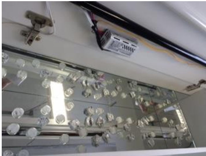
Figura 11: Câmera espelhada com lâmpada de irradiação UVA/UVB e lâmpada branca fluorescente, utilizada na execução dos ensaios de fotoestabilidade dos lactobionatos de sódio, potássio e cálcio e do ácido lactobiônico.
