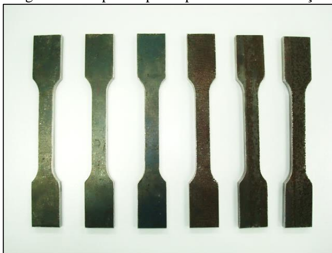
Figura 7 - Corpos de prova para o ensaio de tração
