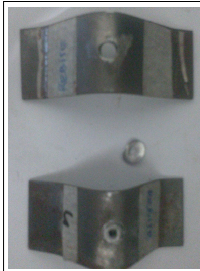
Figura 26 - Falha da junta rebitada – Ensaio de tração pura
