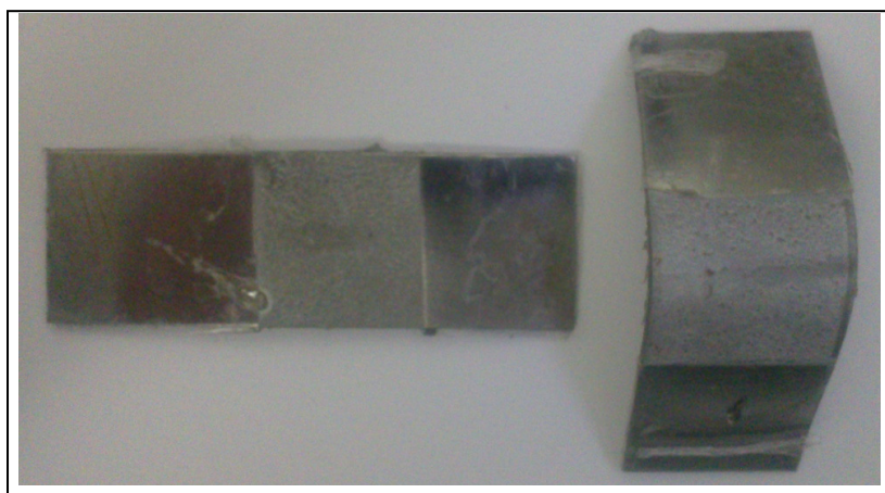
Figura 28 - Falha da junta adesiva lixada – Ensaio de tração pura
