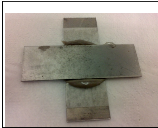
Figura 21 – Corpo de prova de junta adesiva – Ensaio de tração pura
