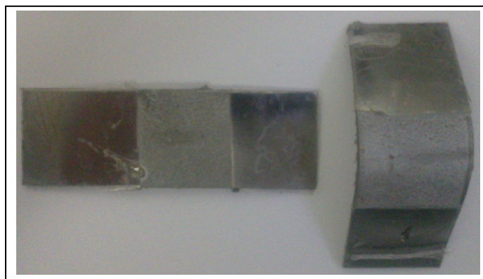
Figura 27 – Falha da junta adesiva laminada – Ensaio de tração pura
