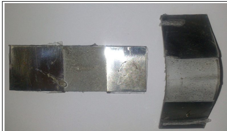
Figura 29 - Falha da junta adesiva polida – Ensaio de tração pura
