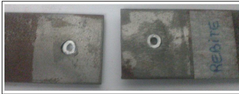
Figura 25 - Falha da junta rebitada – Ensaio de cisalhamento
