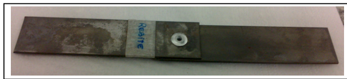
Figura 18 – Corpo de prova de junta rebitada – Ensaio de cisalhamento
