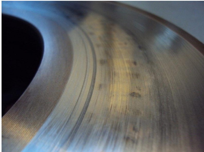
Figura 8 – Aspecto superficial do platô de embreagem após teste
