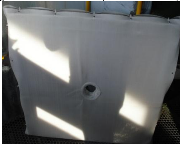
Figura 4.13 – Placa revestida pelo tecido de filtração
