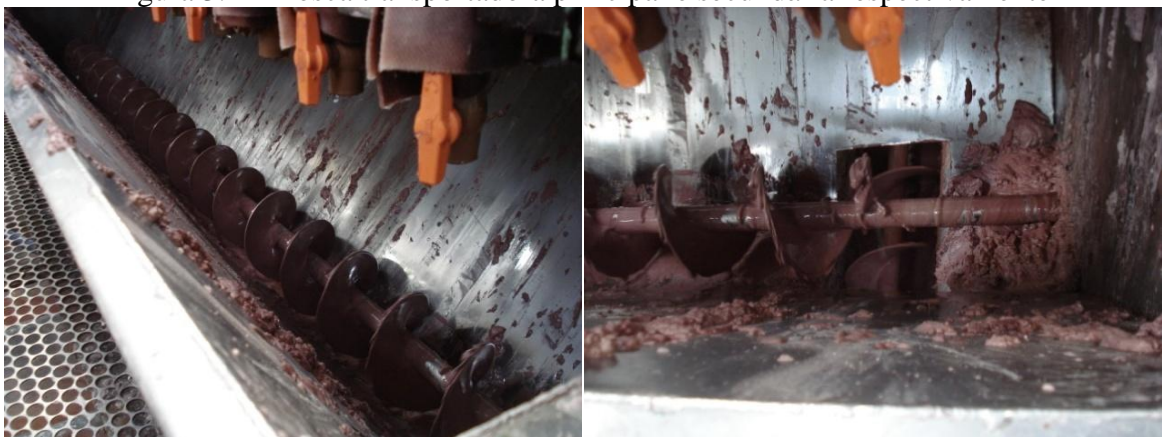
Figura 3.4 – Rosca transportadora principal e secundária respectivamente
