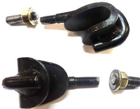
Figura 20 – Grampos que apresentaram falha.
