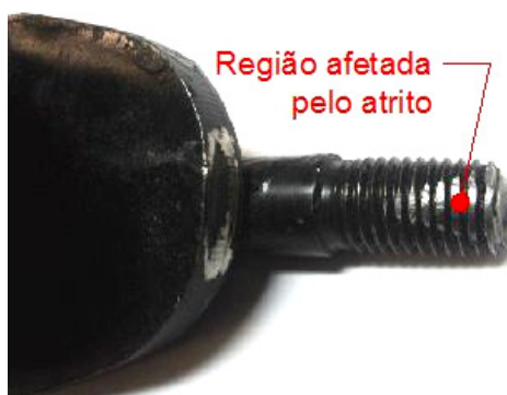
Figura 21 – Grampo com marca de desgaste na região da rosca.
