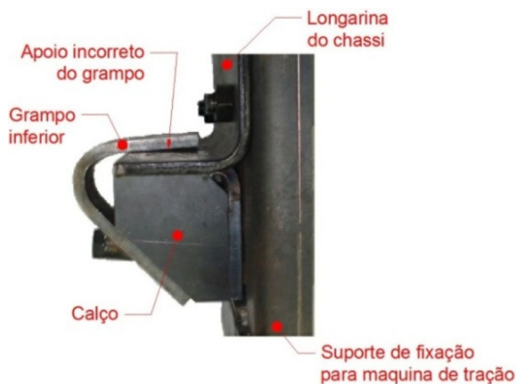
Figura 33 – Problema de assentamento do grampo.
