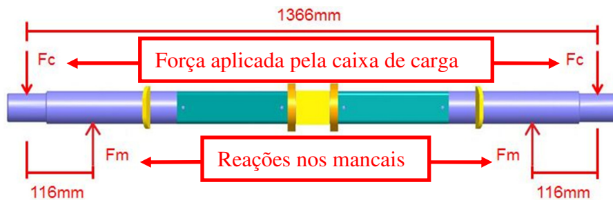
Figura 19 – Diagrama de corpo livre do eixo
