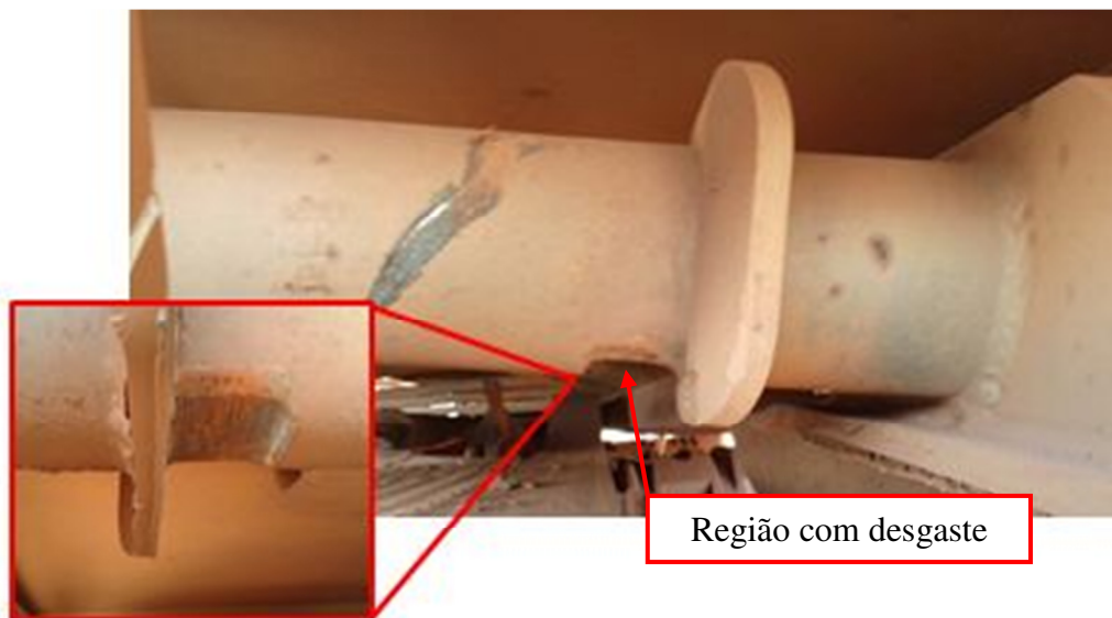
Figura 13 – Amostras com desgaste
