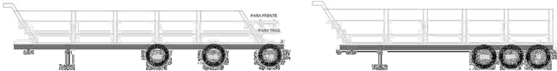
Figura 1 – Basculante convencional (direita), basculante deslizante (esquerda).
