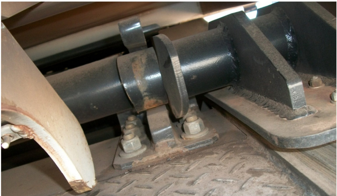
Figura 10 – Região da falha do eixo
