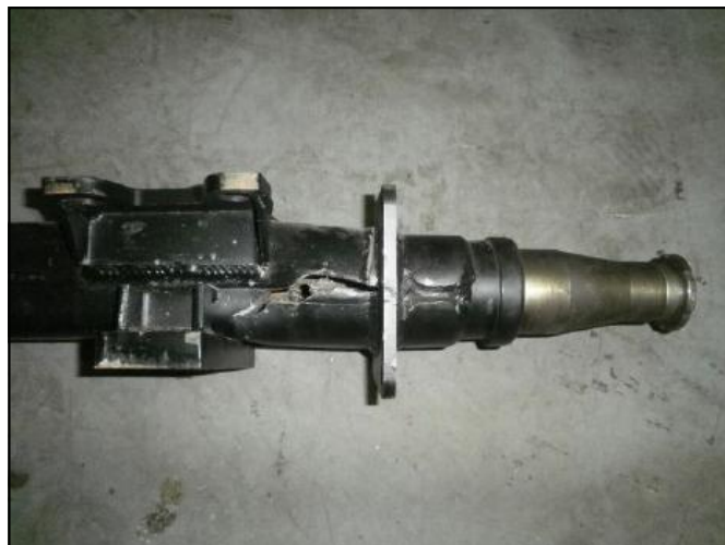
Figura 33 – Ruptura do eixo no ensaio de fixação dos elementos de freio com alavanca de 500 mm
