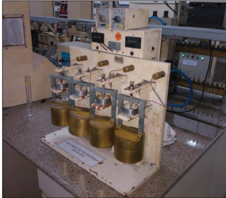
Figura 26 – Dispositivo do teste de vida do conjunto diafragma
