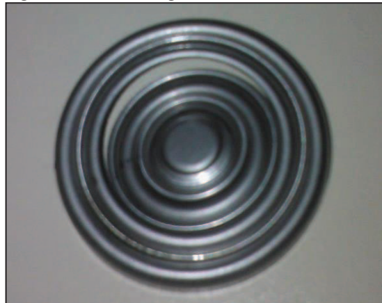
Figura 4 – Diafragma EAP047 fraturado
