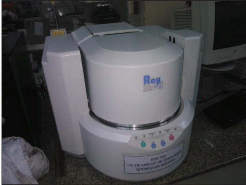
Figura 29 – Espectrômetro de raios-x Shimadzu modelo EDX-720
