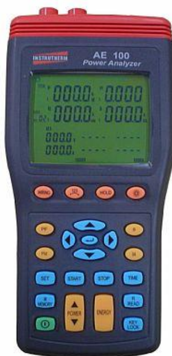
Figura 19 – Analisador de energia da marca Instrutherm, modelo AE 100
