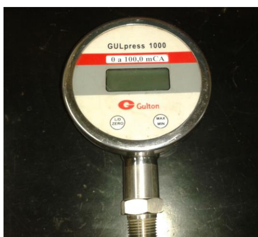
Figura 15 – Manômetro de 0 a 100 mca da marca Gulton, modelo Gulpress 1000
