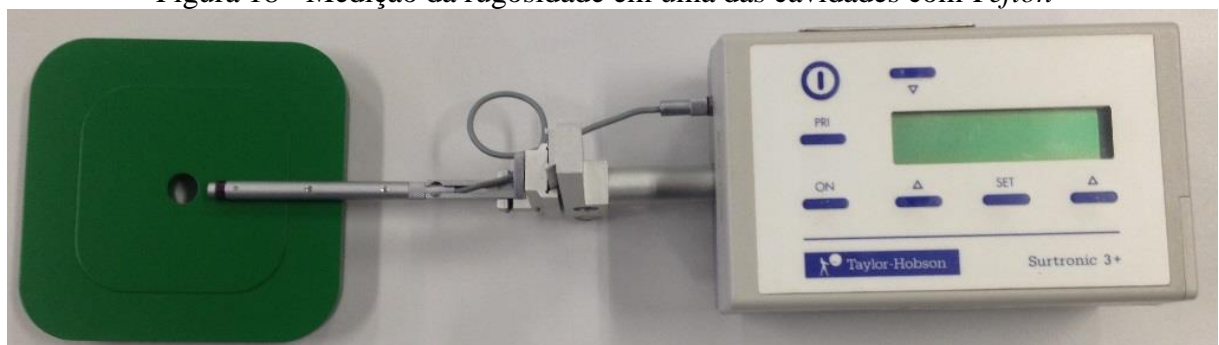
Figura 18 - Medição da rugosidade em uma das cavidades com Teflon ®
