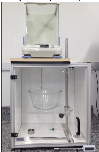
Figura 23 - Dispositivo de medição de Arquimedes para obtenção da massa submersa
