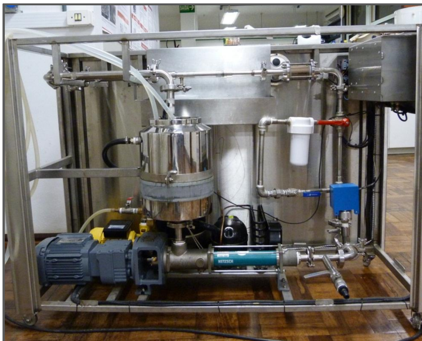
Figura 40: Sistema de microfiltração utilizado nos ensaios de permeabilidade.
