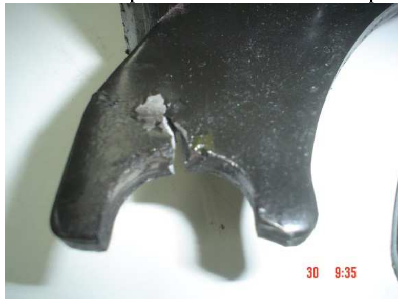
Figura 22 – Patim com Ruptura no Came Analisado no Campo de Provas
