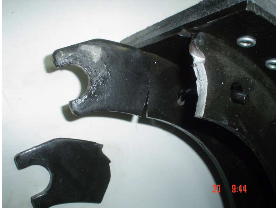
Figura 21 – Patim com Ruptura no Corpo Analisado no Campo de Provas
