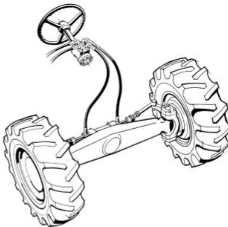
Figura 6 – Representação sistema de direção hidrostática.
