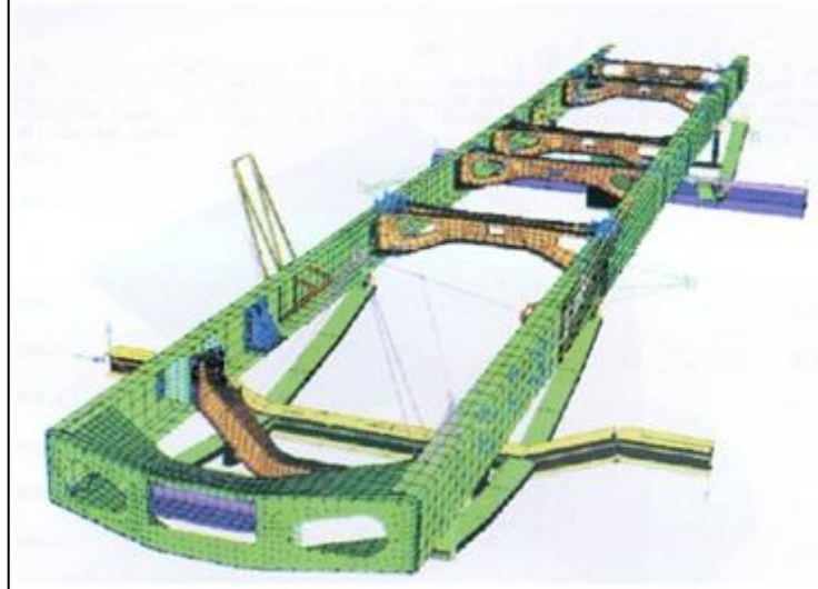
Figura 11 - Aplicação do elemento de casca em uma estrutura de um chassi
