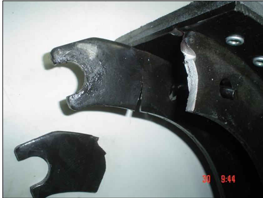
Figura 33 – Patim com quebra na região crítica
