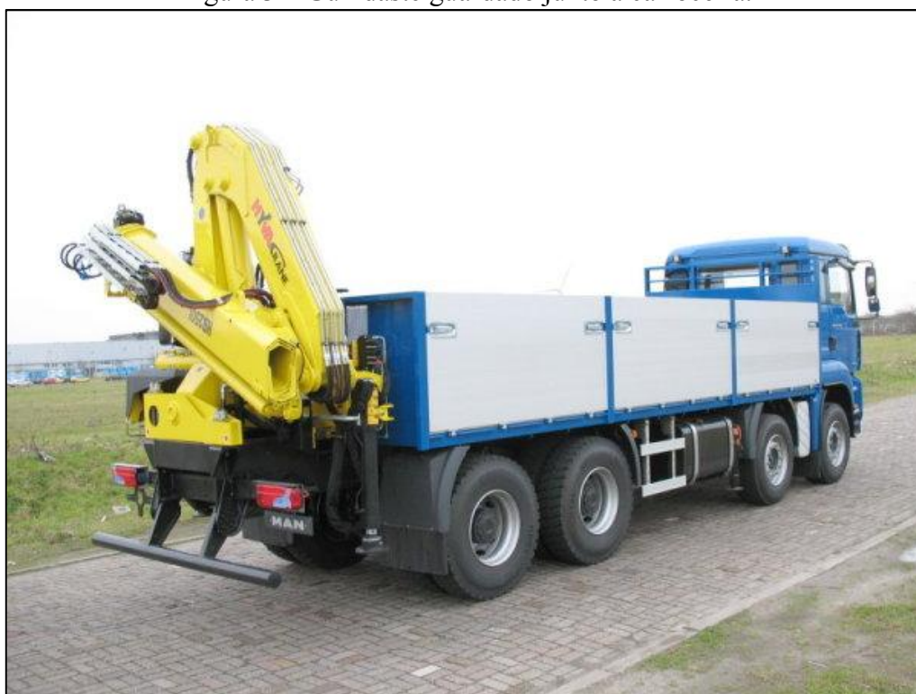
Figura 3 – Guindaste guardado junto a carroceria.
