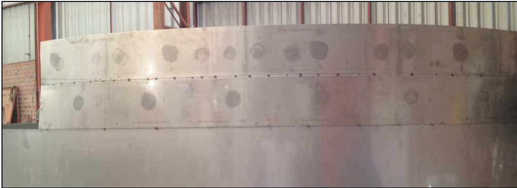
Figura 9 - Corpo de prova para processo de soldagem GTAW automatizado
