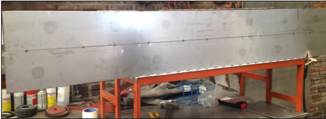
Figura 11 - Corpo de prova para processo de soldagem GMAW manual
