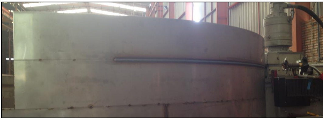
Figura 12 - Corpo de prova para processo de soldagem GMAW automatizado
