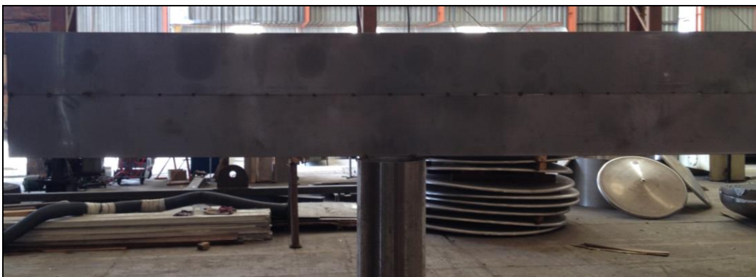
Figura 10 - Corpo de prova para processo de soldagem GTAW manual
