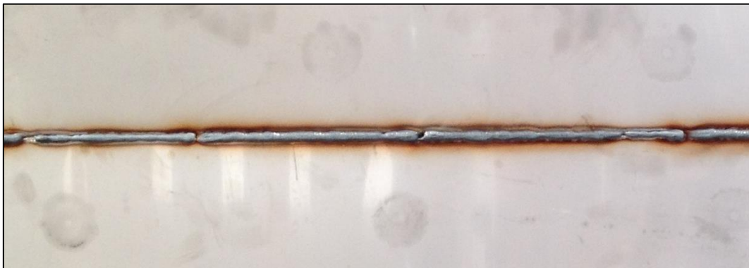
Figura 22 – Cordão de solda GMAW Manual
