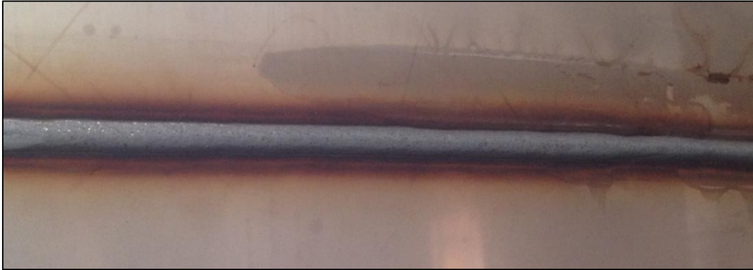
Figura 21 – Cordão de solda GMAW Automatizado
