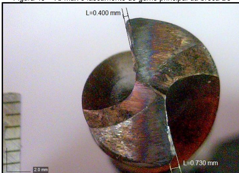
Figura 49 - V_b \text{ Max} e lascamento do gume principal da broca B5
