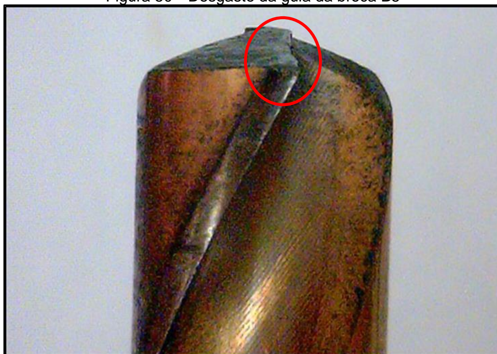
Figura 50 - Desgaste da guia da broca B5
