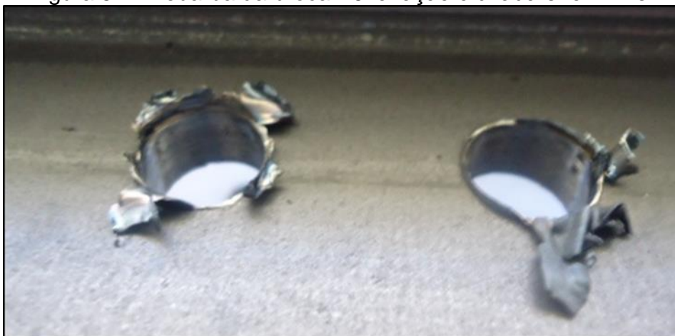
Figura 57 - Rebarba da broca B6: afiação cruzada e \sigma = 118^\circ
