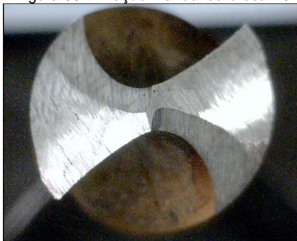
Figura 39 - Afiação manual da broca B3
