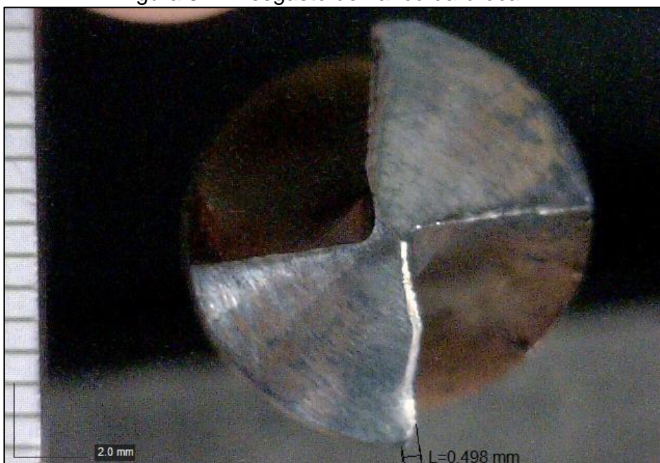
Figura 34 - Desgaste de flanco da broca B2
