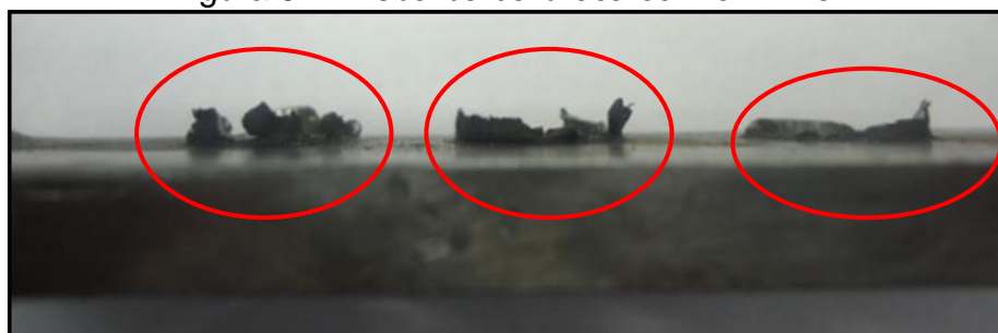
Figura 61 - Rebarba da broca com \sigma = 118^\circ
