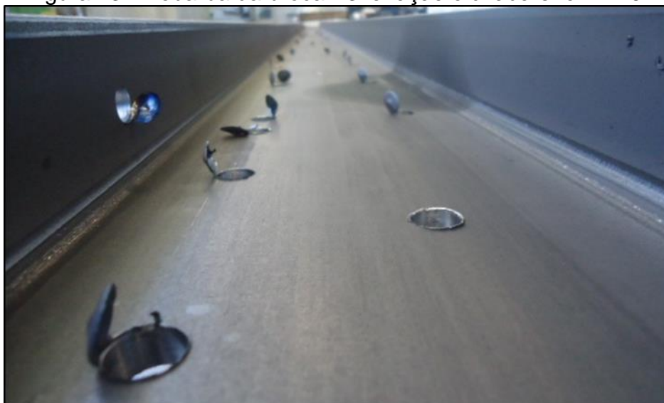
Figura 43 - Rebarba da broca B3: afiação cruzada e \sigma = 140^\circ
