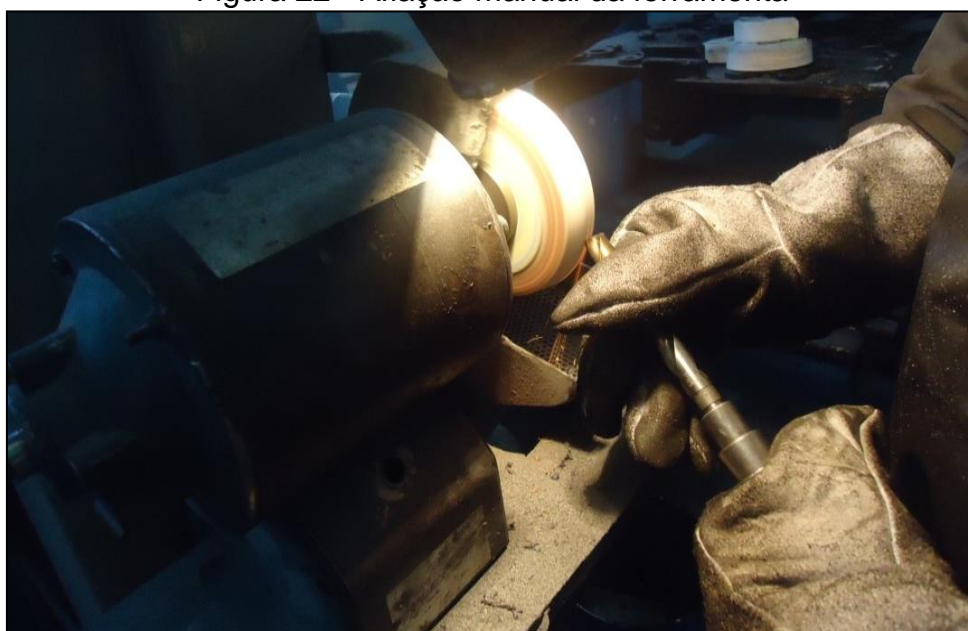
Figura 22 - Afiação manual da ferramenta
