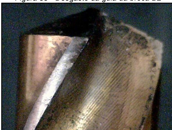
Figura 35 - Desgaste da guia da broca B2
