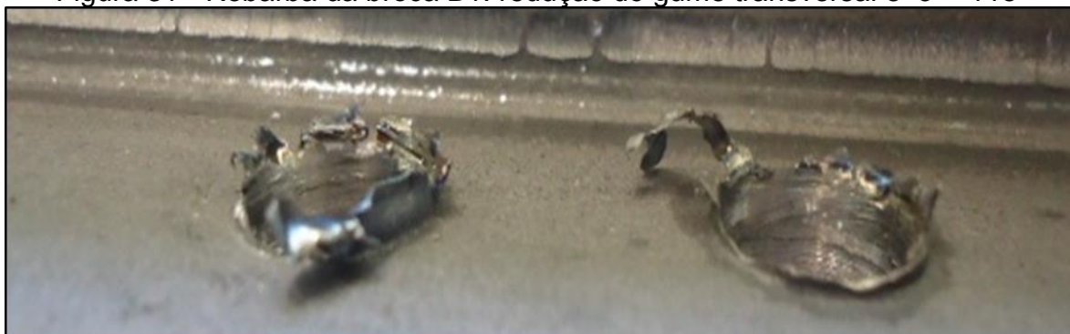
Figura 31 - Rebarba da broca B1: redução do gume transversal e \sigma = 118^\circ
