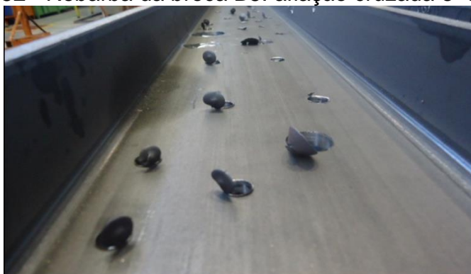
Figura 52 - Rebarba da broca B5: afiação cruzada e \sigma = 140^\circ
