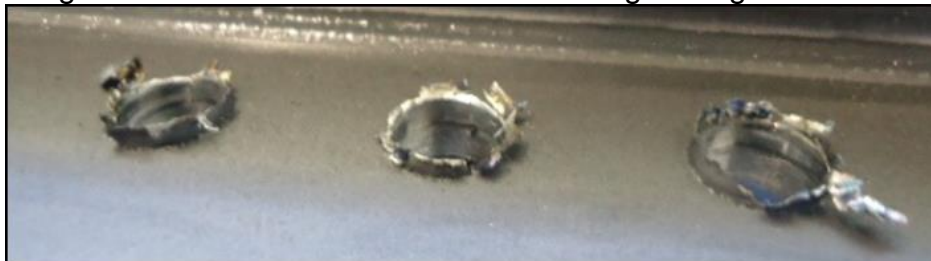
Figura 26 - Rebarba das brocas com o ângulo original de 118^\circ
