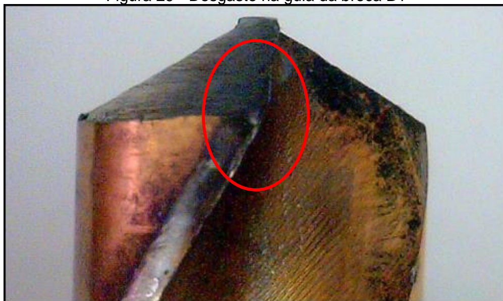
Figura 29 - Desgaste na guia da broca B1
