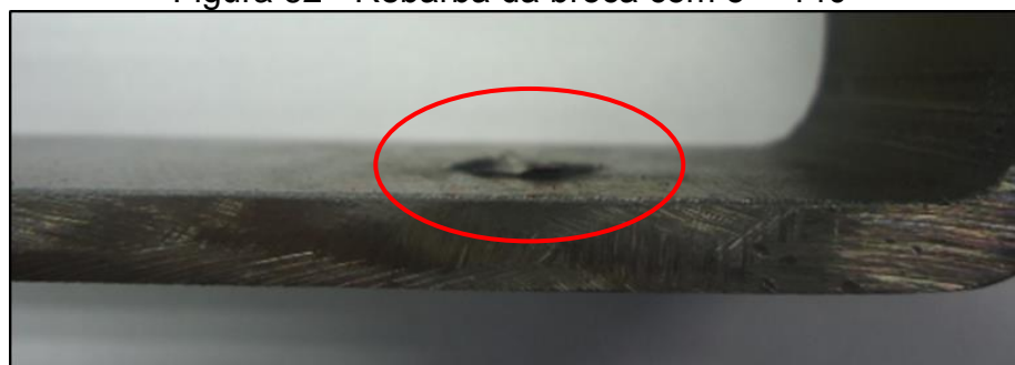
Figura 62 - Rebarba da broca com \sigma = 140^\circ
