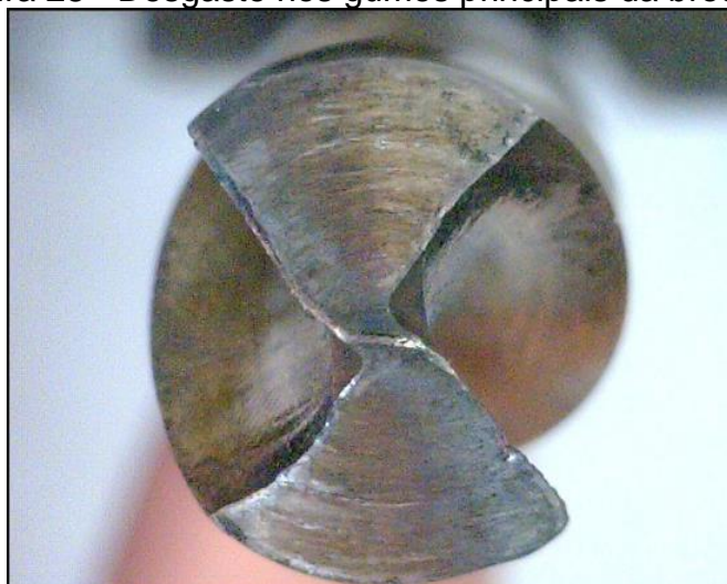
Figura 28 - Desgaste nos gumes principais da broca B1
