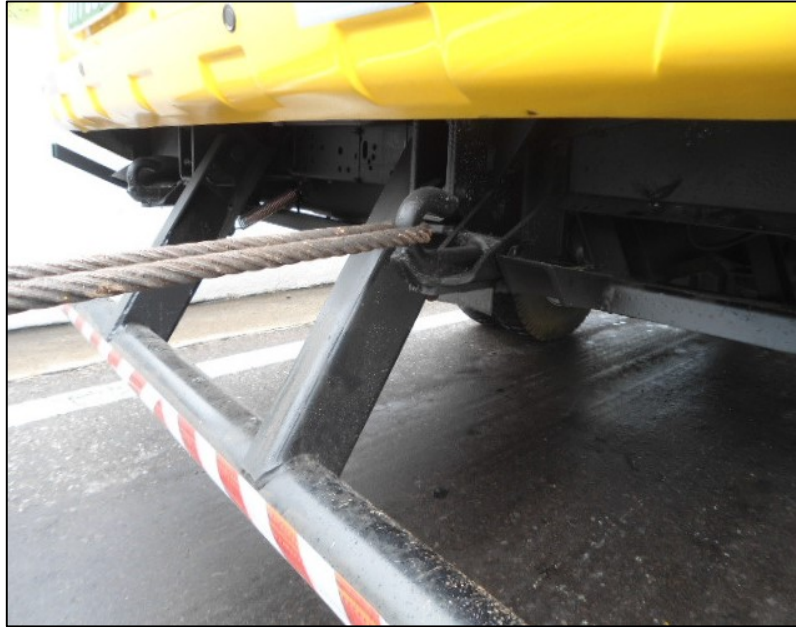
Figura 23 - Rebocagem paralela ao elemento de rebocagem
