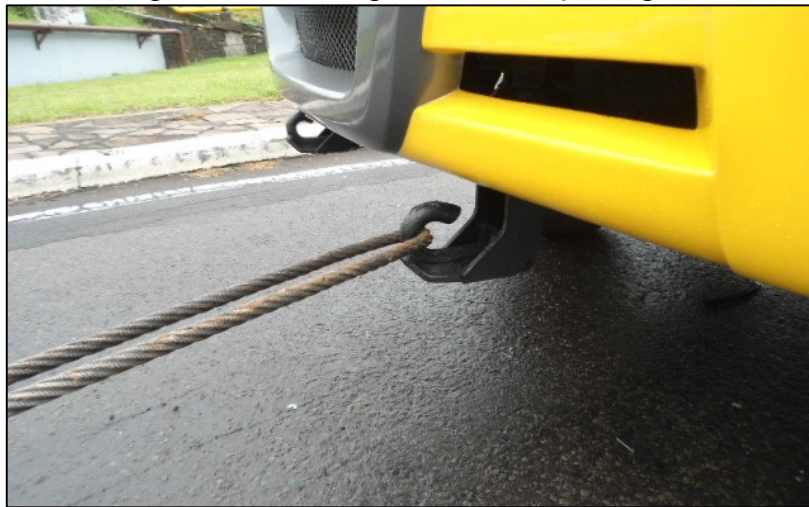
Figura 25 - Rebocagem com variação angular
