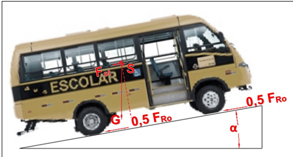
Figura 22 - Análise das forças de movimento do veículo
