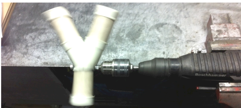
Figura 14 - Misturador "Y" montado em furadeira
