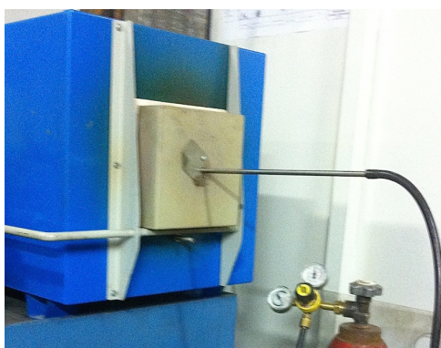
Figura 18 - Método para insuflar o gás protetor
