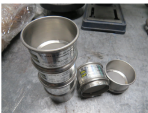
Figura 9 - Peneiras com sequência normalizada conforme SAE J-444
