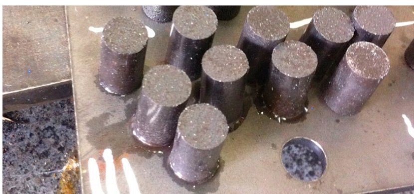
Figura 34 - Fusão precoce do lubrificante
