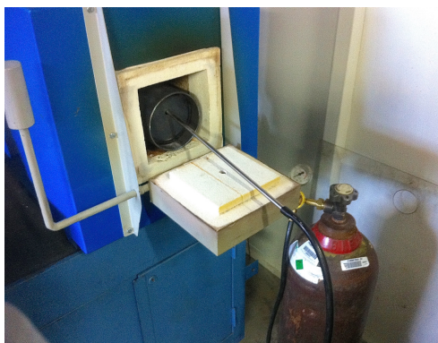
Figura 18 - Método para insuflar o gás protetor
