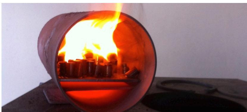
Figura 35 - Combustão do lubrificante em contato com a atmosfera (~250°C)
