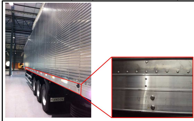
Figura 24 - Detalhe da junta parafusada semirreboque furgão
