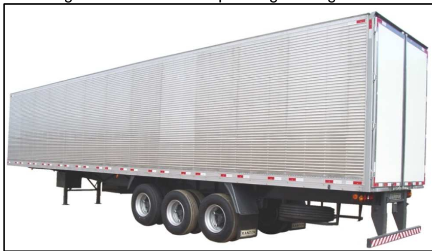
Figura 23 – Semirreboque Furgão Carga Geral
