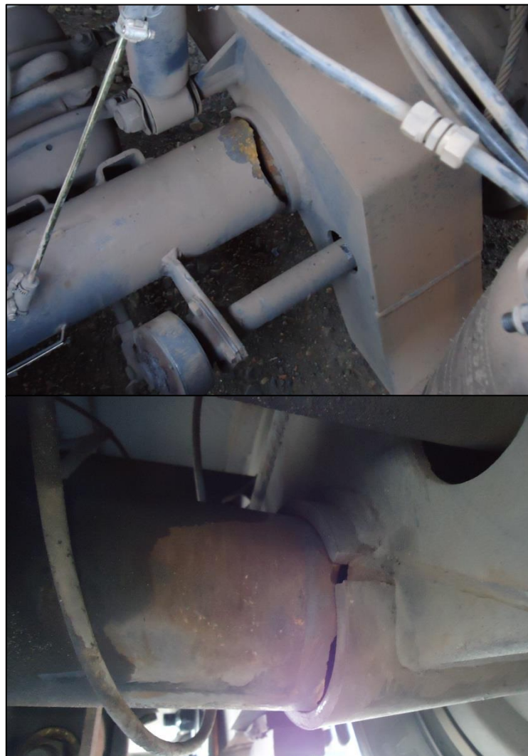
Figura 17 – Suspensão apresentando falha em campo
