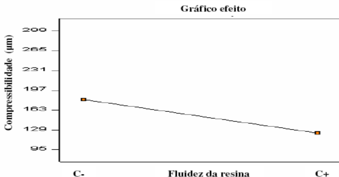
Figura 43 – Gráfico da variação da compressibilidade a frio em função da fluidez da resina – DOE 3.
