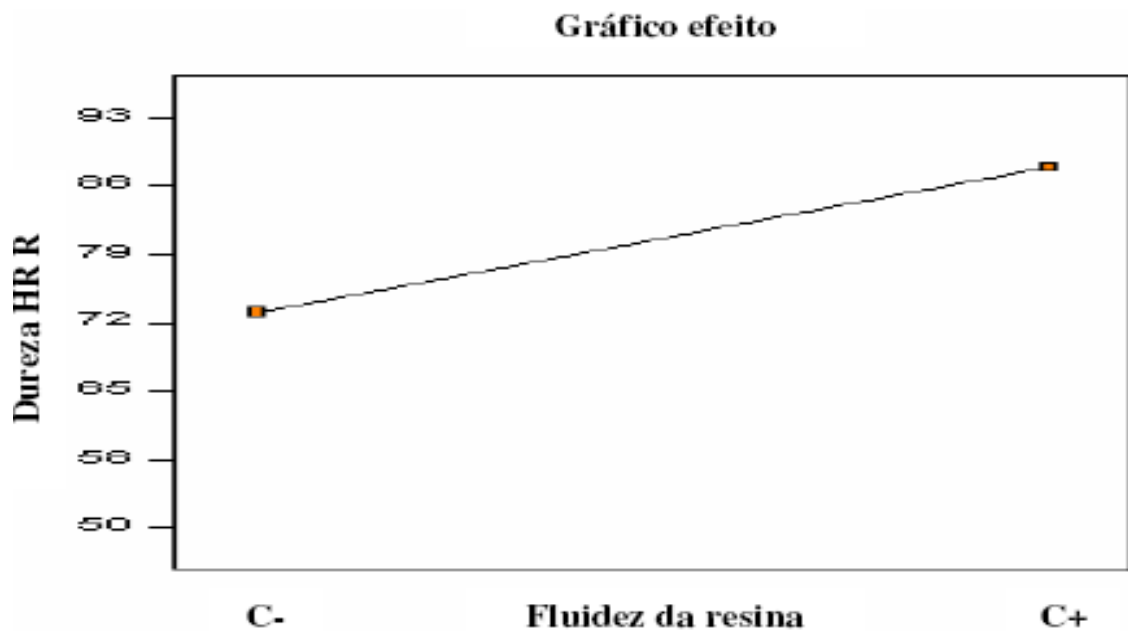
Figura 40 – Gráfico da variação da dureza HRR em função da fluidez da resina – DOE 3.
