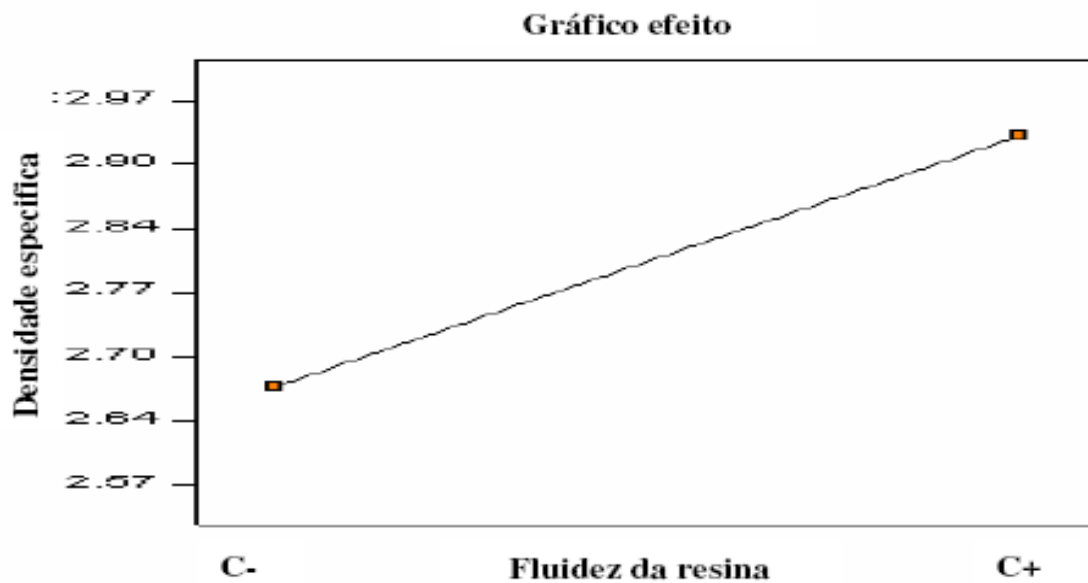
Figura 37 – Gráfico da variação da densidade específica em função da fluidez da resina – DOE 3.
