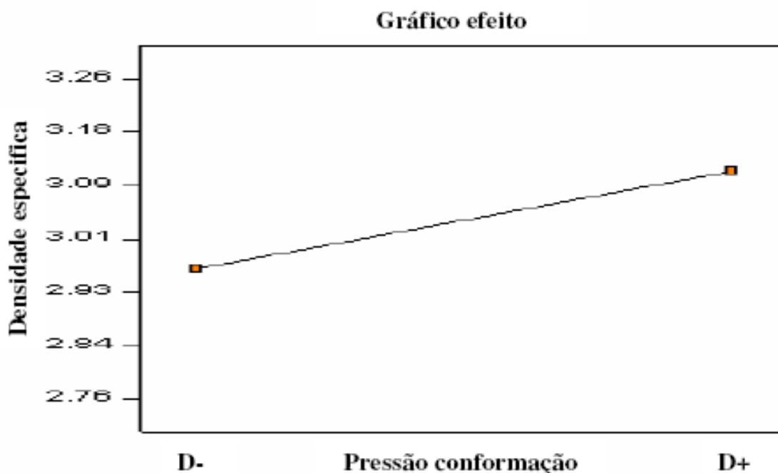
Figura 14 – Gráfico da variação da densidade específica em função dos níveis de pressão de conformação a quente – DOE 1.
