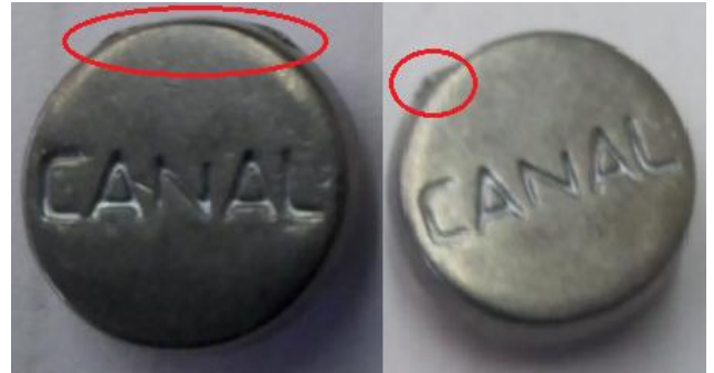
Figura 21 – Rebarbas de gate .
