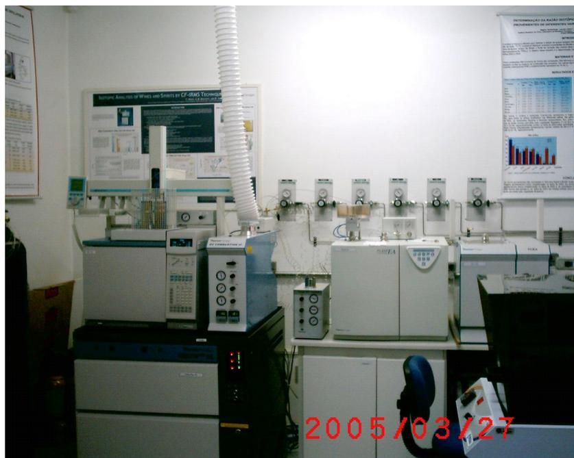
**Figura 4-** Foto do espectrômetro de massas de razão isotópica modelo Delta<sup>plus</sup> XI, Finnigan, com os analisadores elementares e o cromatógrafo GC/TC.
