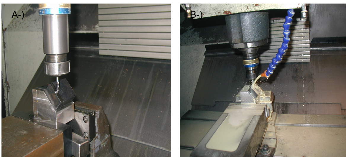
Figura 3.4 – Usinagem dos corpos-de-prova na etapa 1.
