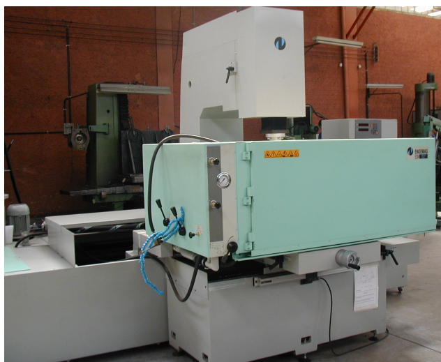
Figura 3.8 – Máquina Eletroerosão Engemaq, da empresa JR Oliveira, onde foram realizados os ensaios de usinagem por erosão
