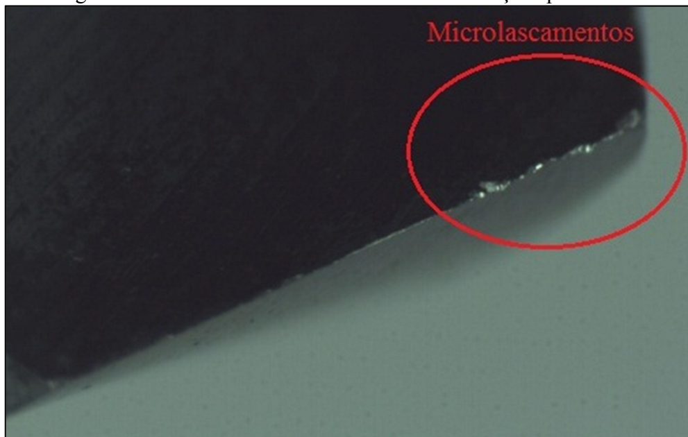
Figura 18 – Microlascamentos em uma broca de aço-rápido nova.
