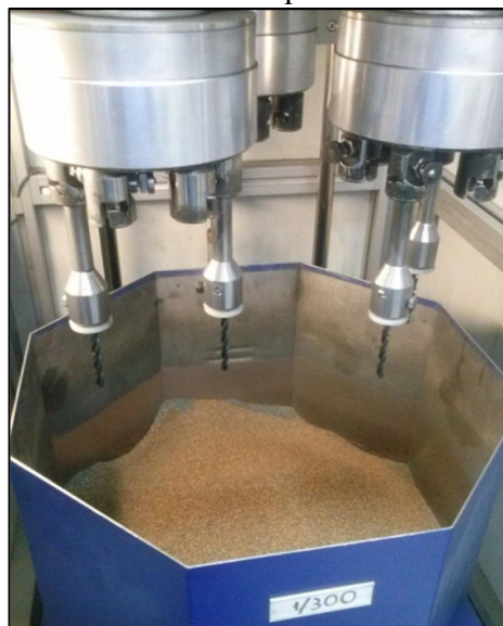
Figura 11 – Características da máquina Otec DF-3 Tool.
