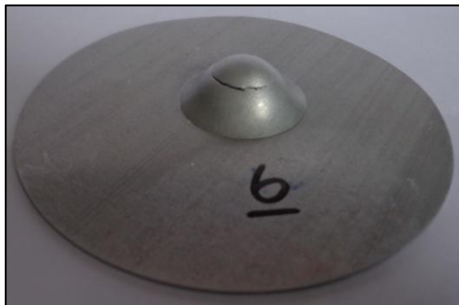
Figura 24 – Fratura em um corpo-de-prova do ensaio Erichsen.
