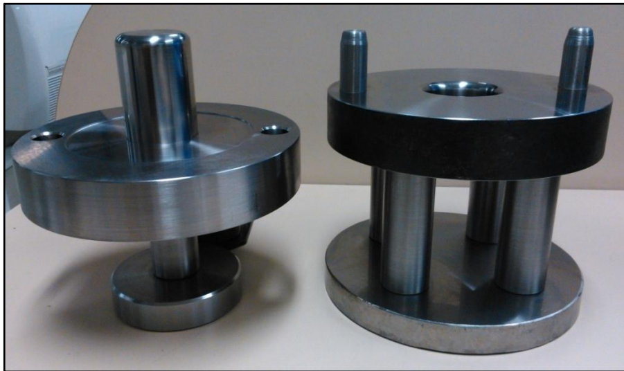
Figura 12 – Ferramenta para o Ensaio Swift finalizada.
