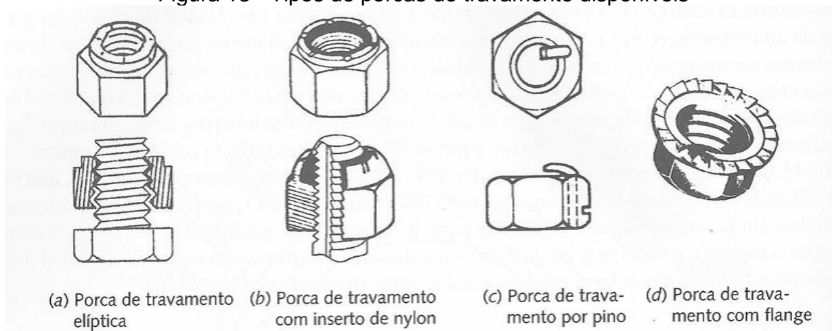
Figura 13 - Tipos de porcas de travamento disponíveis
