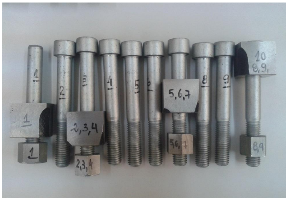
Figura 19 - Corpos de prova pinça do freio
