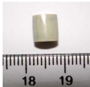
Figura 24: Fotografia da amostra de \alpha -ZrW 2 O 8 processada em 7,7 GPa por 30 min.
