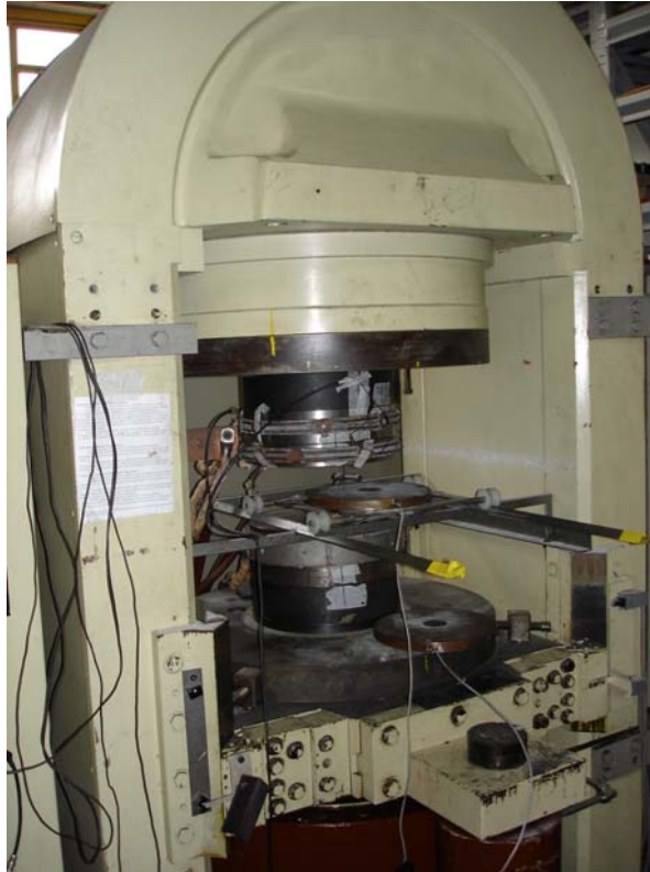
Figura 19: Fotografia da prensa hidráulica do LAPMA/UFRGS onde as amostras deste trabalho foram processadas.
