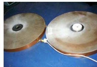
Figura 20: Representação esquemática (Adaptado da Ref. [89]) e fotografia da câmara toroidal com uma gaxeta cerâmica ao centro.
