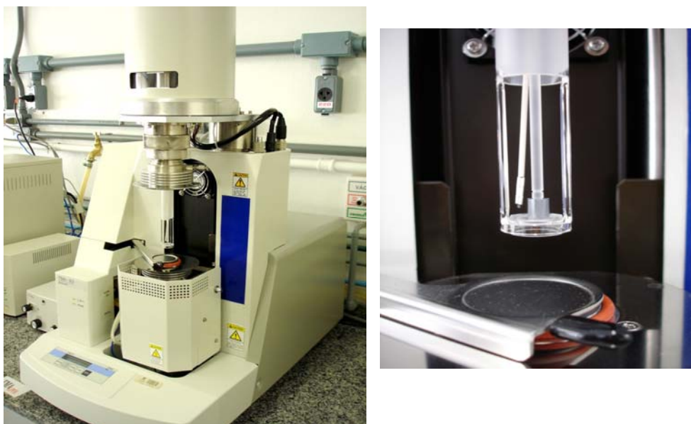
Figura 25: À esquerda: fotografia do equipamento de análise termomecânica. À direita: vista do porta amostras.
